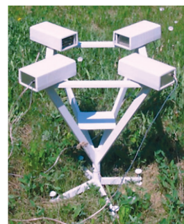
Рис. 87. Опико-электронный двухканальный измеритель атмосферных осадков: принцип действия (слева) и внешний вид (справа).
