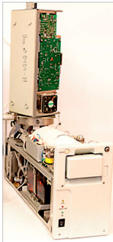
Рис. 85. Макет портативного высокочувствительного экспрессного газового хроматографа ЭХО-СПИП с рекордно низким порогом обнаружения паров тринитротолуола на уровне 10^{-16} г/см 3 .
