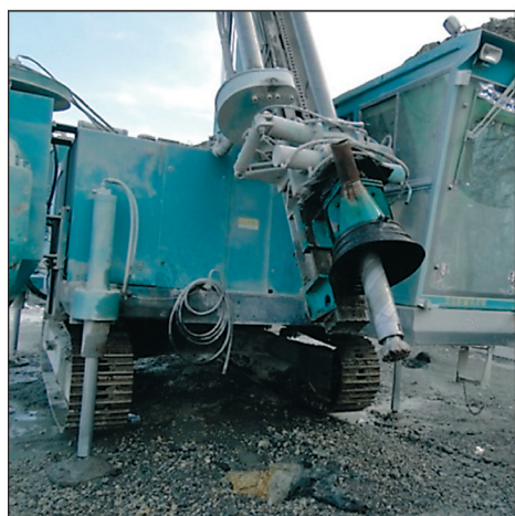
Рис. 53. Пневмоударник ПВ170М на буровом станке SWDB165 на карьере «Борок» (слева) и графики скоростей бурения пневмоударниками (справа).
