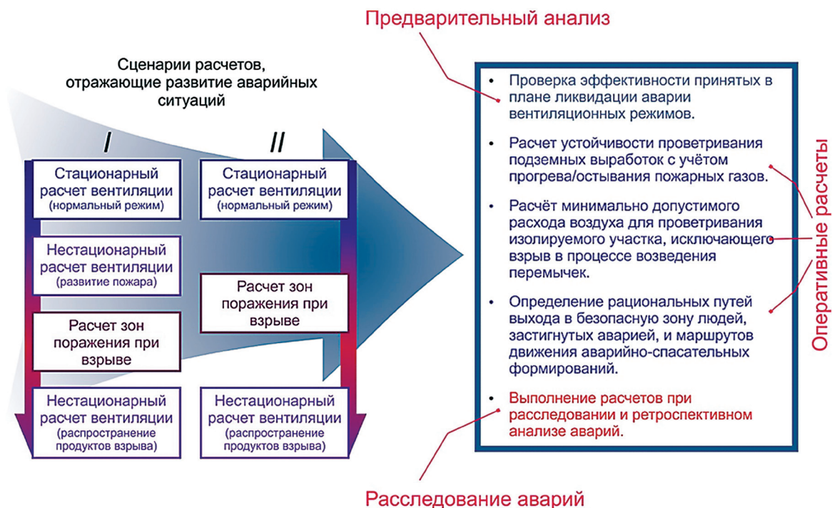
Рис. 52. Схема газодинамической модели расчета нестационарных режимов проветривания угольных шахт.
