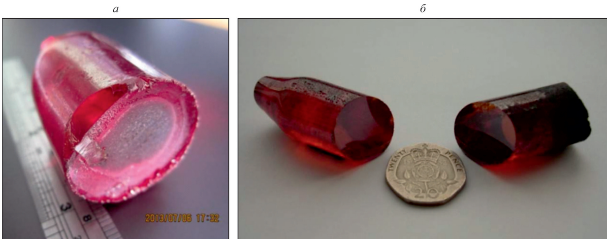
Рис. 10. Внешний вид кристаллов, легированных серой: GaSe:S (0,15 мас.%) (а) и GaSe:S (11 мас.%) (б).
