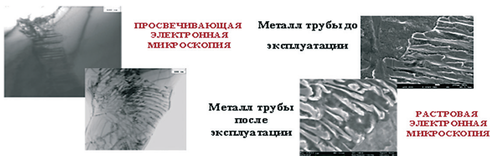
Рис. 44. Сравнение результатов исследования структуры стали 09Г2С, полученных АСМ, просвечивающей и растровой электронной микроскопией.
