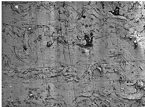
Рис. 10. Микроструктура покрытия Ni–Co–Cr–Al–Y, полученного на плазмотроне ПНК-50.
