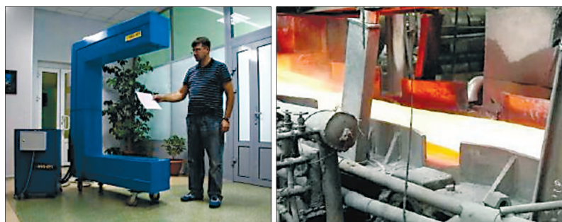
Рис. 12. Внешний вид лазерного измерительного комплекса ЛАД-0Р 3 (слева) и рабочий момент – точное и бесконтактное измерение толщины горячей полосы металла (справа).
