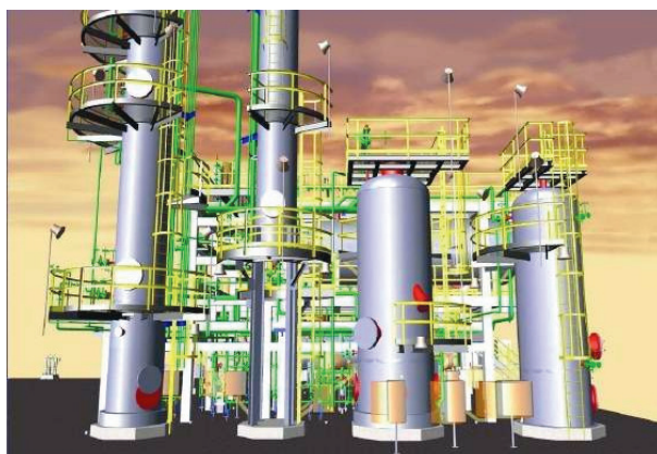
Рис. 9. Разработанный проект вихревого экстрактора ИК (фотография процесса получения эмульсионного слоя — слева) позволит в 10 раз уменьшить размеры тарельчатых колонн процесса жидкофазной очистки углеводородов (рис. справа — в центре).
