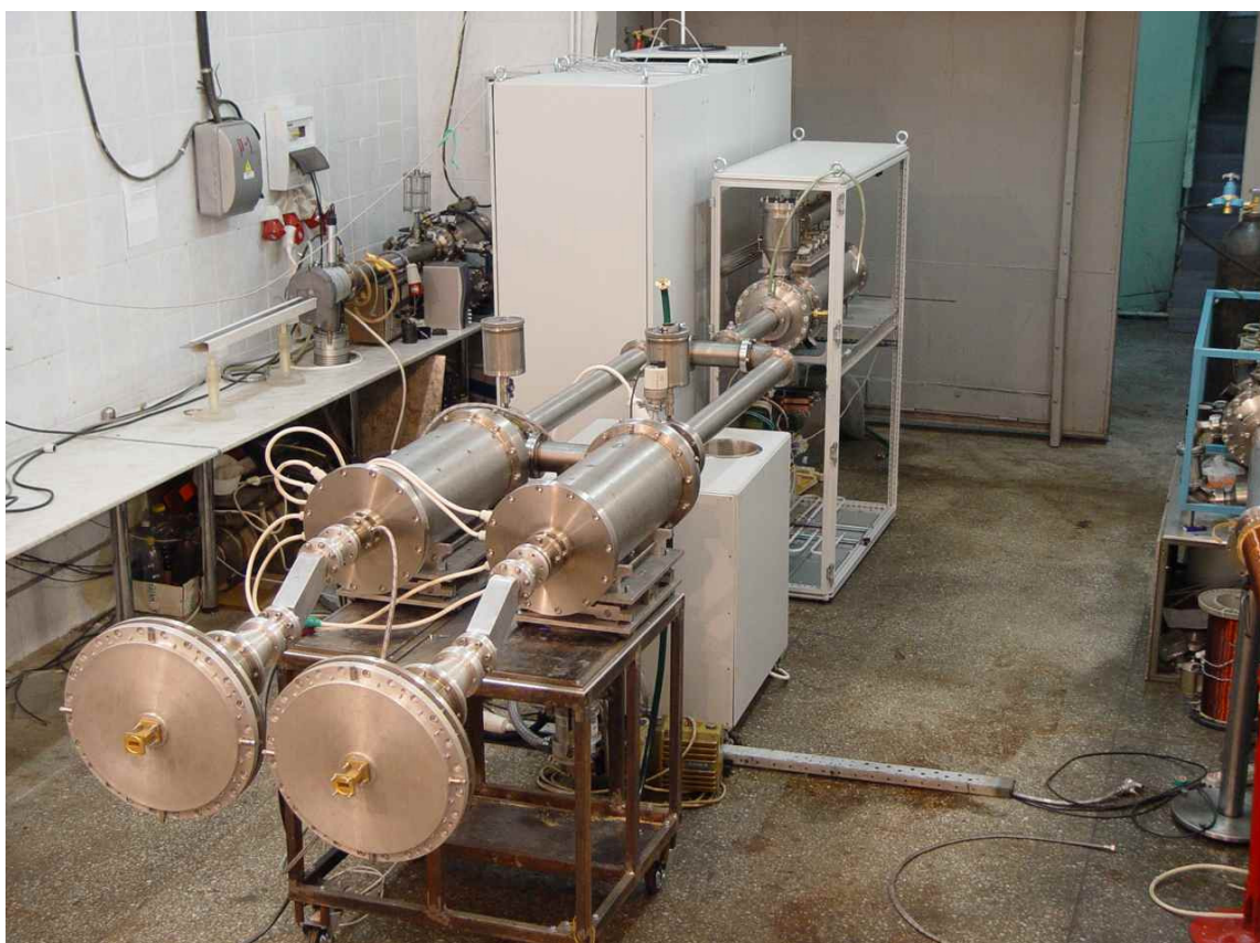
Рис. 35. Внешний вид источника с пристыкованным калориметром на каждом канале.
