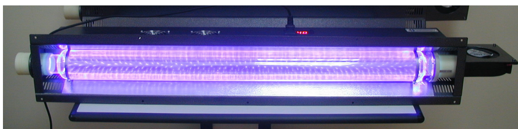
Рис. 38. Эксилампа с выходным окном размером 80 \times 11 см.
