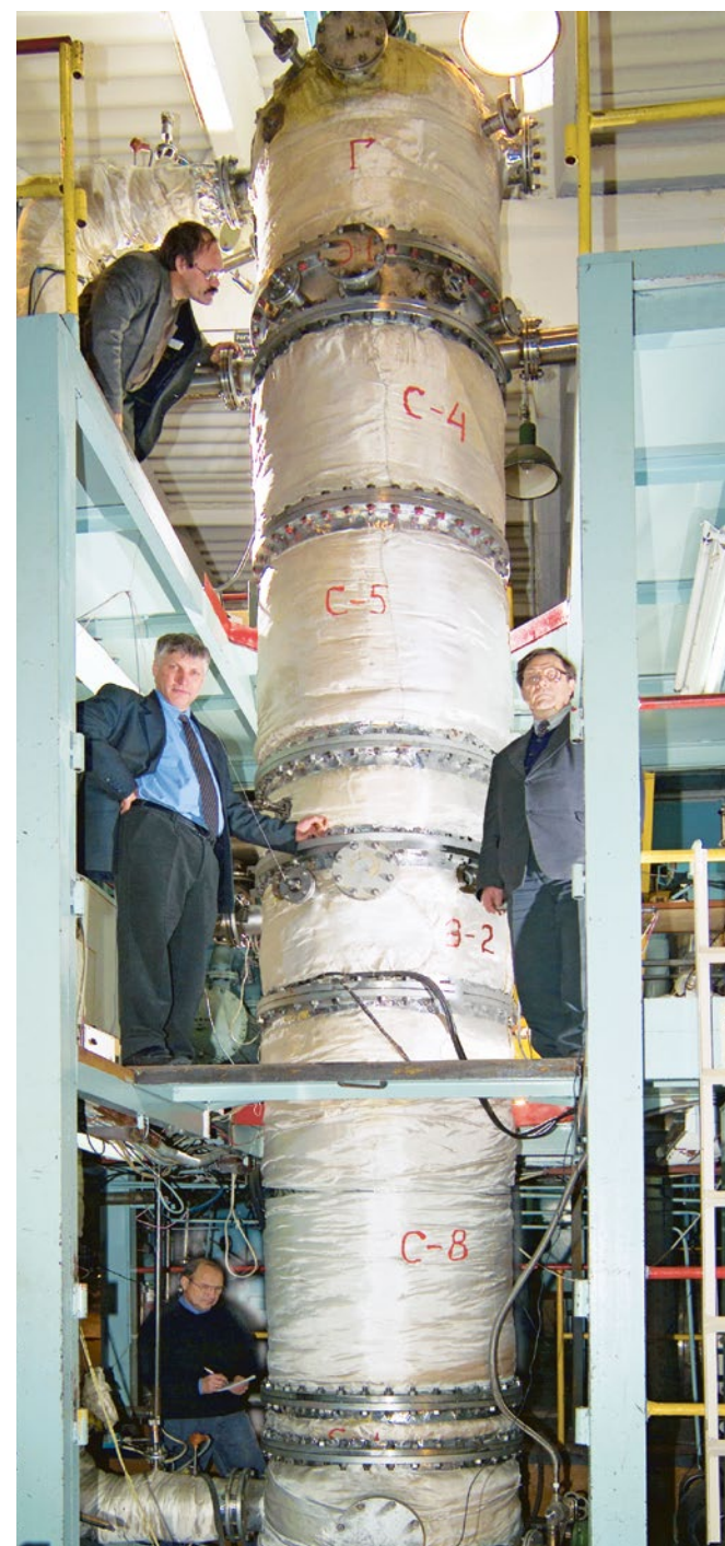
Не имеющая на сегодня аналогов в мире крупномасштабная экспериментальная модель дистилляционной колонны со структурированной насадкой
