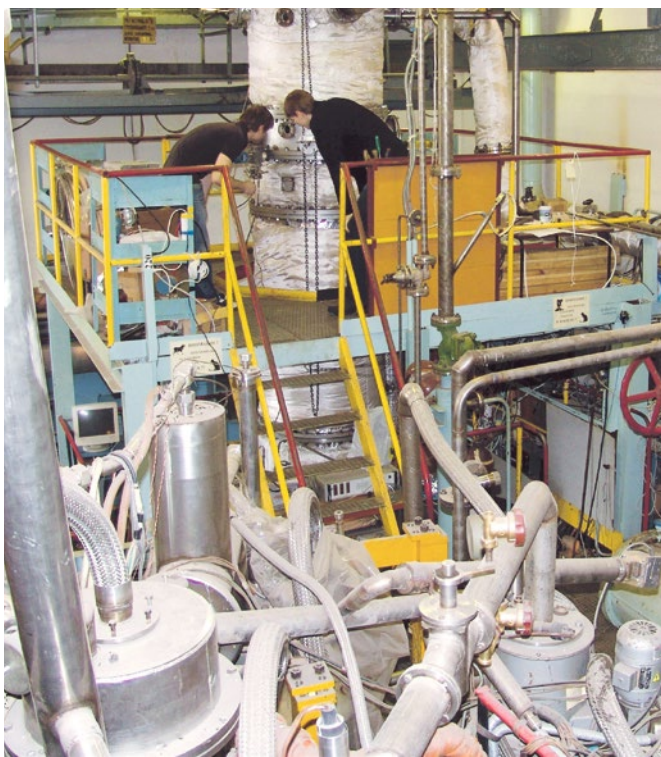
Головная (верхняя) часть дистилляционной колонны с теплообменниками для конденсации паров смесей фреонов
