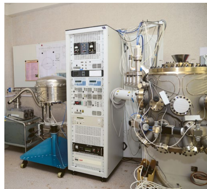
Установка для создания многослойных полупроводниковых структур в космосе и имитатор космического вакуума
