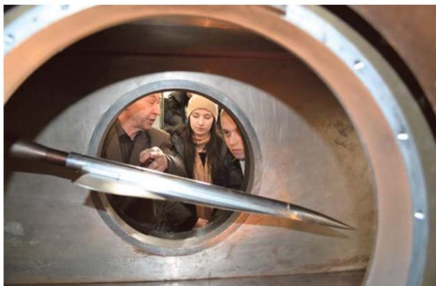
Д.т.н. В.И. Корнилов знакомит школьников с Т-313 (на переднем плане – модель сверхзвукового самолета в рабочей части трубы)
