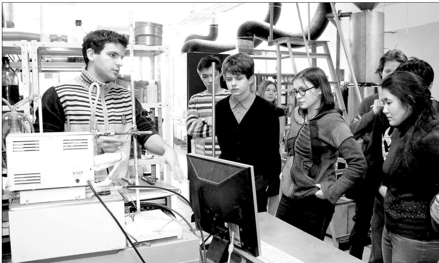
На снимках Е. Трухиной: — футуристическая конструкция, обнаруженная ребятами в одной из лабораторий — это рентгеновский фотоэлектронный спектрометр. В основе метода рентгеновской фотоэлектронной спектроскопии лежит явление внешнего фотоэффекта, то есть эмиссии фотоэлектронов из вещества при облучении поверхности образца рентгеновским излучением.
