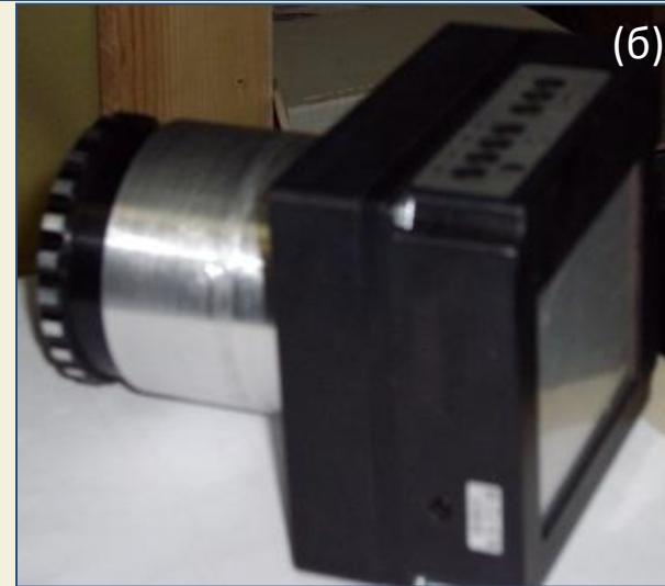
Общий вид микроболометрической головки (а) и тепловизионной камеры (б)
