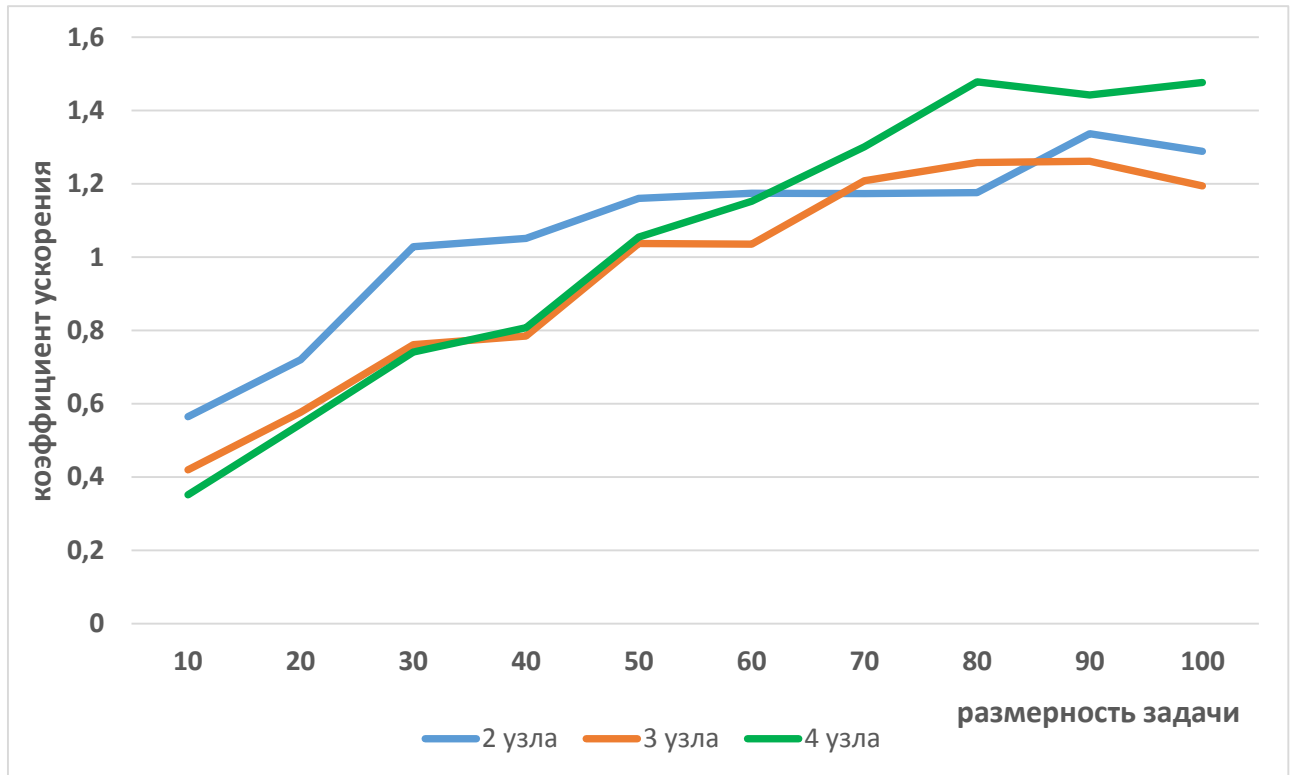
Рис.3.7. График коэффициентов ускорения поиска глобального оптимума на 2-х, 3-х, 4-х узлах с точностью 1e-20 .
